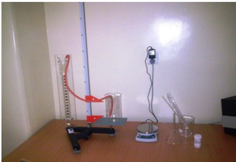
Rysunek 2.2. Zestaw pomiarowy do badania ciśnienia hydrostatycznego.
